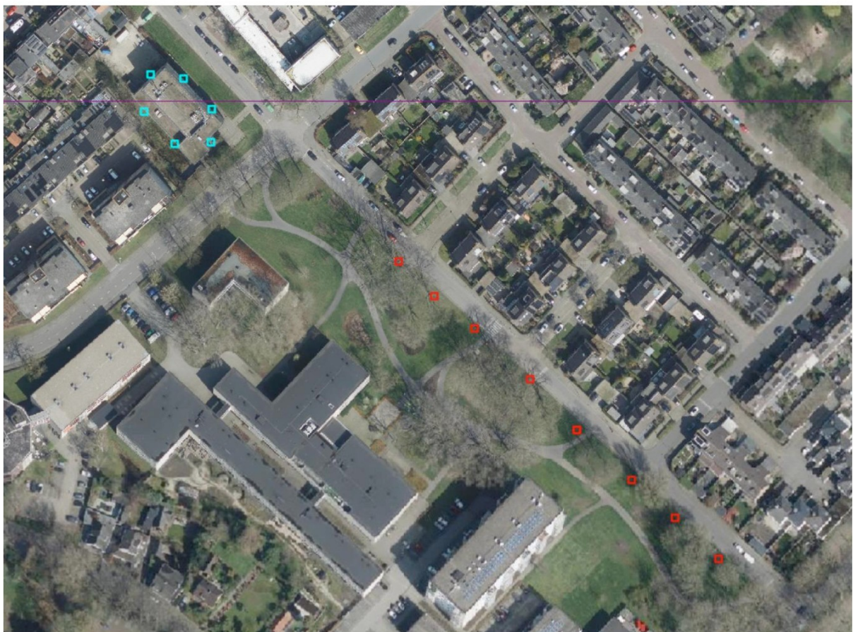
Figuur 4-3 Principe opzet bemaling met in blauw de deepwells en in rood de retourbronnen
